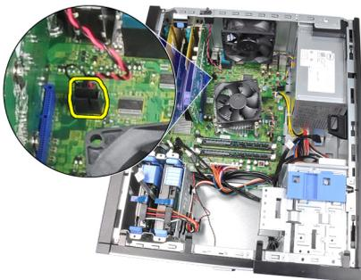
4. Deslice el interruptor de intrusiones hacia la parte inferior del chasis y extáigalo.
