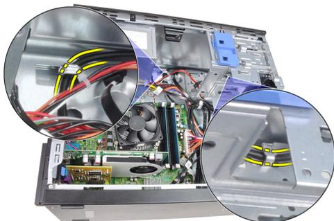
7. Saque el cable del interruptor de alimentación del gancho del chasis.
