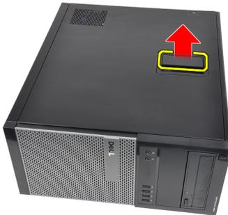
3. Levante la cubierta hacia arriba con un ángulo de 45 grados y retírela del equipo.
