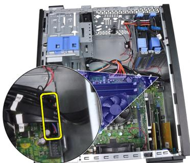
5. Desenrosque el panel de entrada/salida y el cable FlyWire del gancho del equipo.
