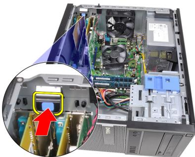
4. Tire suavemente de la palanca de liberación de la tarjeta PCIe x16 hasta que se suelte la pestaña de fijación de la hendidura de la tarjeta. Después deslice la tarjeta para sacarla de su conector y extraerla del equipo.
