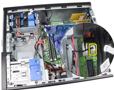
4. Saque el cable del sensor térmico del gancho del chasis.
