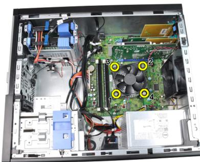
5. Levante suavemente el ensamblaje del disipador de calor y el ventilador y sáquelo del sistema. Apóyelo con el ventilador mirando hacia abajo y con la grasa térmica hacia arriba.
