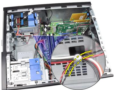
5. Saque con suavidad el sensor térmico de la parte frontal del chasis.
